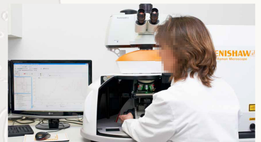
Kombinierter Messplatz: Fourier-Transform-Infrarotspektroskopie / Raman-Spektroskopie
